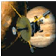
**Orbiter** - Fanno parte di questo gruppo le sonde che analizzano un corpo celeste entrando in orbita attorno ad esso. Sono capaci di operare anche autonomamente, soprattutto quando passano sopra l'emisfero del pianeta opposto alla Terra (interruzione comunicazione) od al Sole (forte escursione termica) (es. Magellan, Galileo, Mars Odissey 2001, ecc...).
