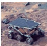
**Rover** - Sonde automatiche semoventi, alimentate da batterie elettriche, che effettuano l'esplorazione della superficie e la ripresa di immagini (es. Sojourner, Jeep lunare, ecc...).
